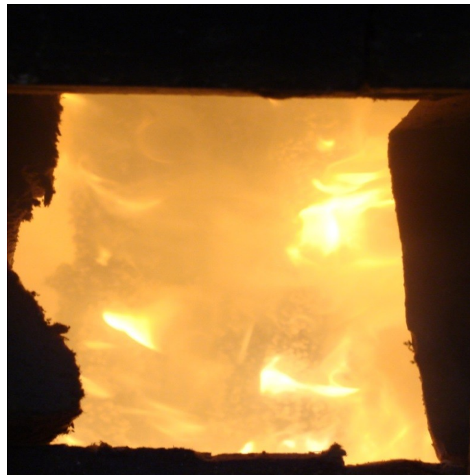
10-я мин испытания, образец № 3, наблюдается крайне интенсивное горение вспученного слоя покрытия, а также значительное выделение дымовых газов (вид в смотровое окно на боковую сторону образца)
