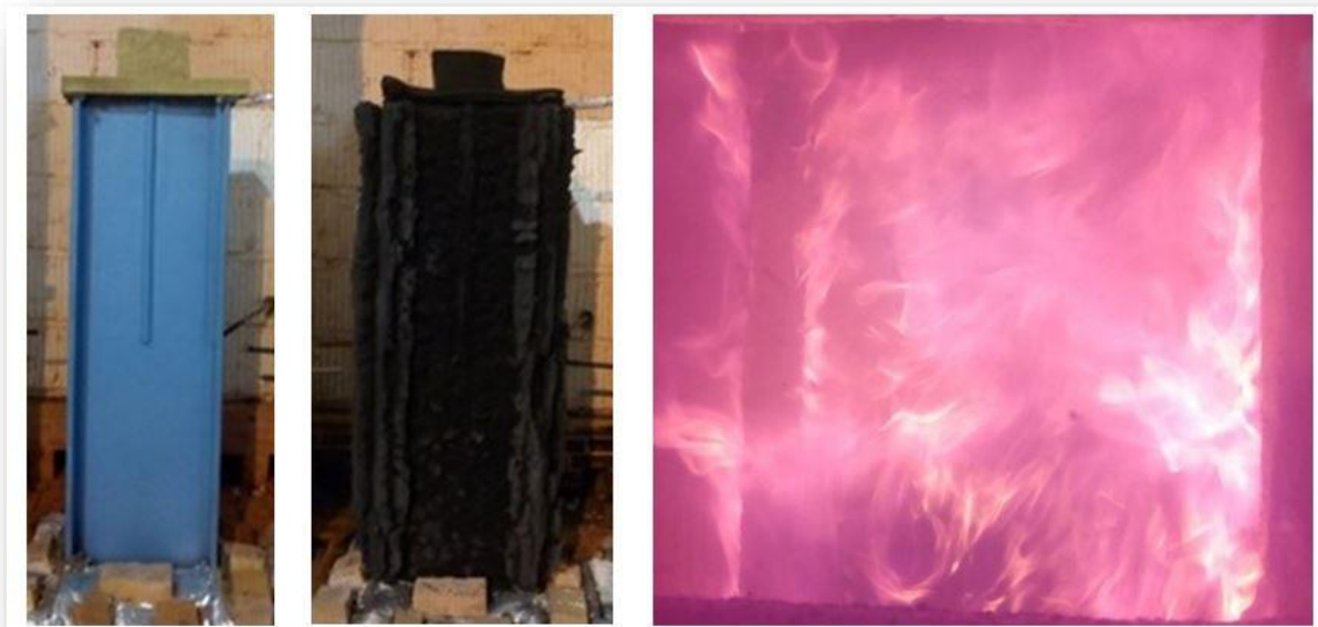
Рис. 2 Испытательный образец с нанесённым интумесцентным составом до испытаний, после испытаний и во время испытаний
