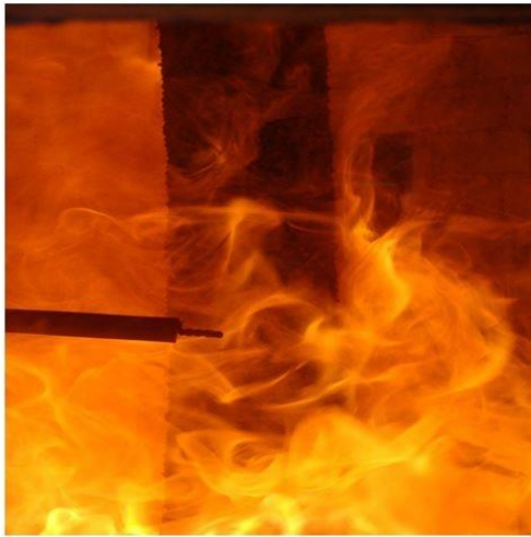
7-я мин испытания, образец № 1, крайне интенсивное горение слоя вспученного слоя покрытия (вид в смотровое окно на боковую сторону опытного образца)
